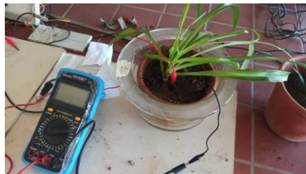
Bio-pile photosynthétique avec la plante d'araignée chlorophytum.
